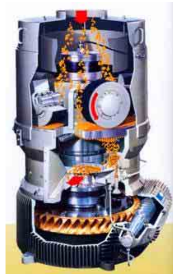
Obrázek 19 - Řez hlavicí maticového lisu. Archiv REC, o. p. s.
