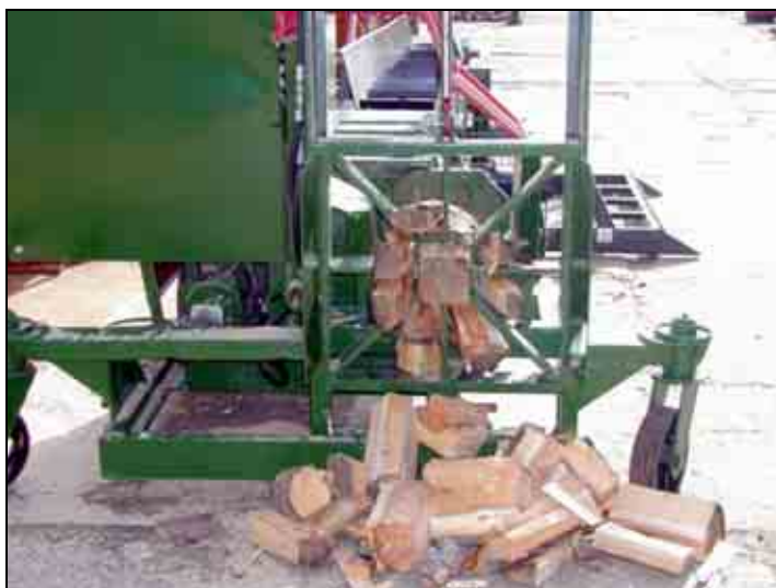
Obrázek 12 - Pila a štípač dřeva. Foto: Bystroň, s. r. o.
