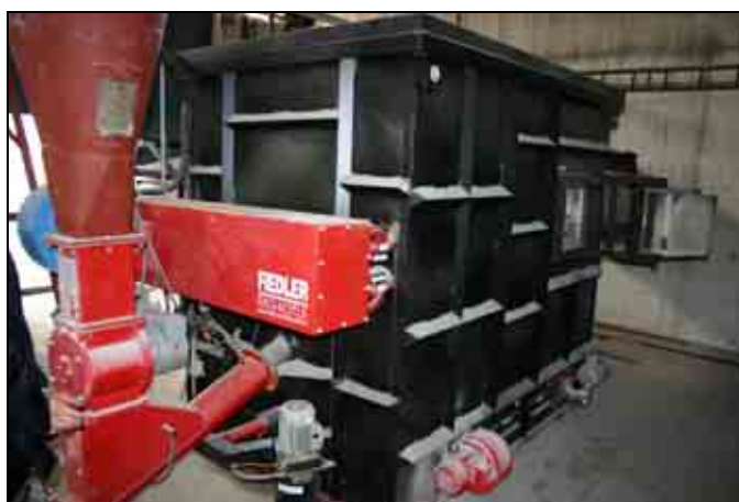
Obrázek 6 - Horkovzdušný kotel peletizační linky v ZD vlastníků Fryšták, který slouží k sušení suroviny pro peletizaci. Jako paliva jsou zde používány různé druhy biopelet vlastní výroby.
