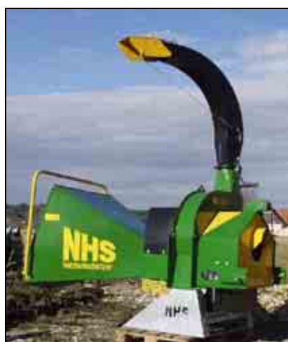
Obrázek 14 - Příklad mobilního štěpkovače za traktor. Foto archiv REC, o. p. s.
