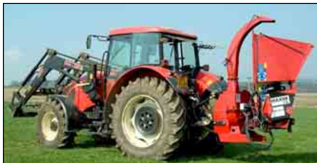
Obrázek 15 - Traktor s přídavným štěpkovačem. Foto archiv REC, o. p. s.
